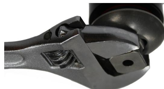
Para ajustar la rotación antes de ensamblar la protesis, use una llave inglesa ajustable para girar la pirámide hasta la posición deseada.
